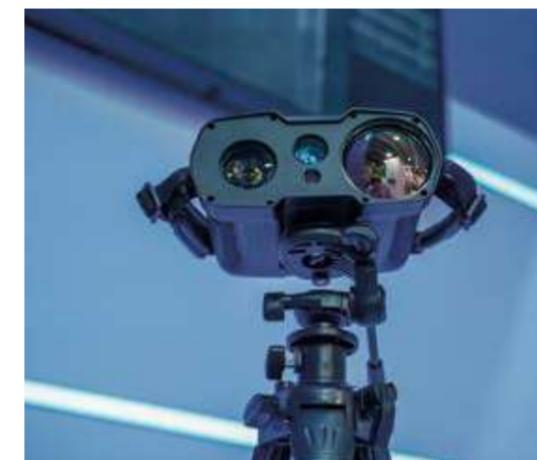
«Блокпост». Он включает в себя наземную оптико-электронную станцию на поворотной платформе, миниатюрный беспилотный летательный аппарат с тепловизором, а также ретранслятор и пульта управления.
