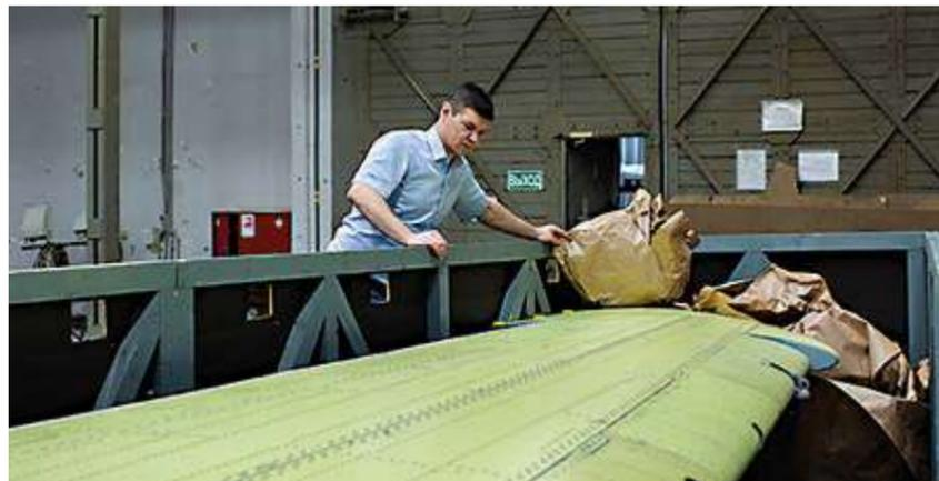
Большой объём исследований реализован в области прочности импортозамещённого авиалайнера. Учёные института провели комплекс расчётно-экспериментальных работ по обеспечению ресурса хвостовой части и стабилизатора, а также зоны крепления двигателя к крылу. Для анализа динамического нагружения конструкции самолёта на взлётно-посадочных режимах в ЦАГИ испытана динамически подобная модель в конфигурации, близкой к натурной при посадке.
