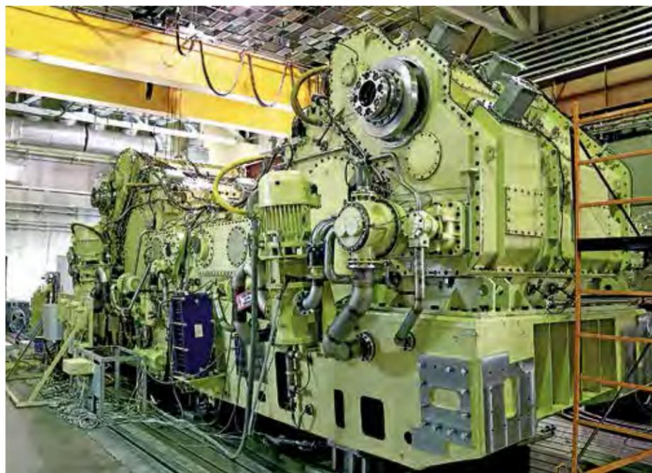
Редукторный комплекс на испытательном стенде
