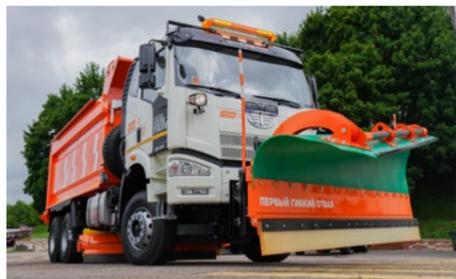
ЭД-490 на базе самосвала FAW CA3250 6x4 в зимней комплектации оснащена рядным дизельным 6-цилиндровым двигателем CA6DL2-39E5 объемом 11,5 л и мощностью 390 л.с., а также 12-ступенчатой коробкой передач. Быстроразъемное навесное оборудование обеспечивает возможность всесезонного использования техники дорожными компаниями на федеральных трассах. От большинства рыночных аналогов модель отлича-
