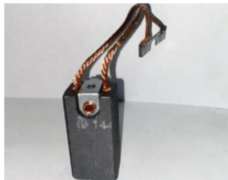
Щетки электрических машин называют скользящие электрические контакты, проводящие ток между неподвижными и движущимися частями различных электротехнических устройств. Преимущественно щетки изготавливаются из графита и применяются для подачи тока на подвижные узлы электродвигателей, генераторов, токоприемников троллейбусов, трамваев, электровозов, оборудования электростанций.
