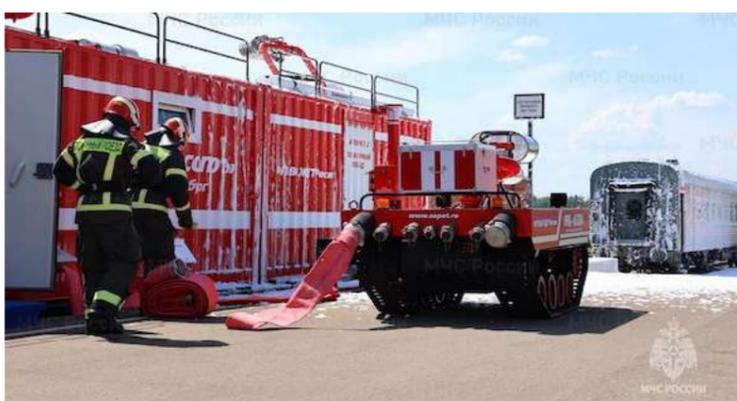
позволяет преодолевать сложные участки местности со скоростью до 30 км/ч. Дальность радиоуправления до 2 километров, с запасом автономного хода до 40 километров.
