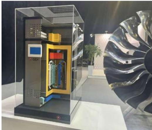
Разрабатываемая энергоустановка предполагает использование в качестве топлива природный газ. Выработка электроэнергии происходит без сжигания топлива, то есть путем электрохимического преобразования синтез-газа в топливных элементах. Так как отсутствует процесс горения топлива, такая установка более экологична и эффективна.
