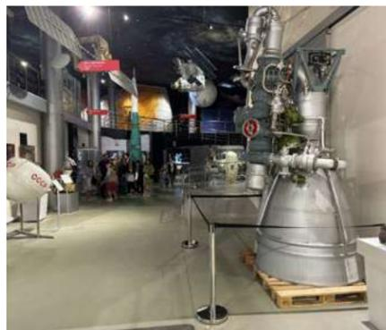
Произведенный опытно-конструкторским бюро Николая Кузнецова ракетный двигатель НК-33 опередил свое время. При его создании использовались прорывные решения: принципиально новая замкнутая схема, минимальный вес относительно тяги, возможность многократного применения, экономичность и чрезвычайная надежность, подтвержденная испытаниями.
