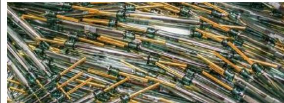
Холдинг «Росэлектроника» создал линейку охранных датчиков на основе герконов. Устройства устанавливаются на дверях домов, транспортных контейнеров, распределительных щитов или трансформаторных подстанций и сигнализируют о случайном или преднамеренном открытии. Применение герконов в составе сигнализаторов позволило увеличить срок службы датчиков и сократить время их срабатывания.
