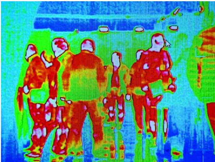
Холдинг «Швабе» создал новейший образец тепловизионной системы для транспорта «Взгляд». Установленное на крышу автомобиля устройство способно обнаружить фигуру человека на расстоянии до 300 м, а на дистанции полукилометра – распознать технику даже в условиях недостаточной видимости. Функционал системы позволяет использовать ее в интересах структур, которые занимаются разведкой местности, охраняют объекты, патрулируют территории, а также проводят поисково-спасательные работы.
