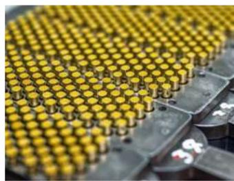
Патроны винтовочные кольцевого воспламенения «Олимп-БИ» используются для проведения соревнований по биатлону и предназначены для стрельбы из короткоствольных винтовок (типа БИ-6, БИ-7). Особенность этих патронов – латунная гильза, которая гарантирует плотное прилегание к поверхности патронника и характеризуется повышенной прочностью и долговечностью. Использование пироксилинового пороха и инновационного капсюль-
